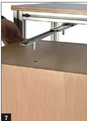
7 Holzarge oben in die Bolzen der oberen Führung stecken.
